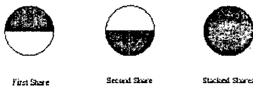
Figure 5.17 : Encoder les pixels à niveau de gris avec des cercles demi-pleins : cas du pixel noir
