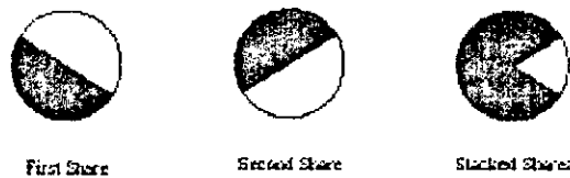
Figure 5.16 : Encoder les pixels à niveau de gris avec des cercles demi-pleins : cas du pixel gris
