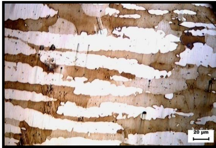
Figure V.13 : Structure du métal de base Après 10h à 475°C.
