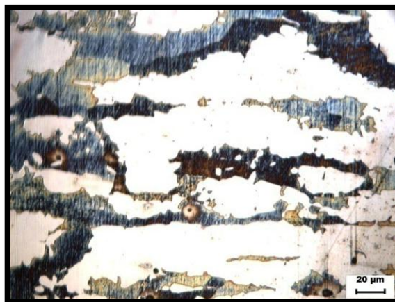
Figure V.5 : Microstructure du métal de base après 50h à 320°C
