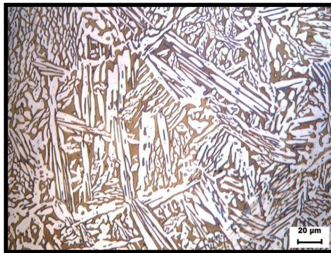
Figure V.16 : Structure de la zone fondue après 10h à 475°C.
