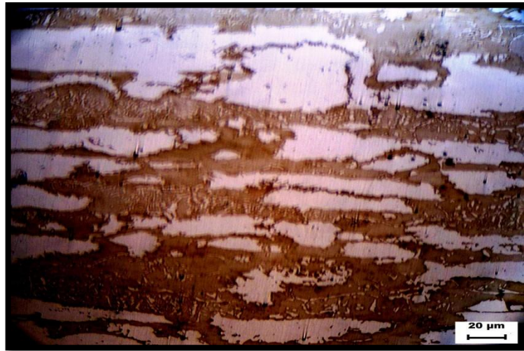
Figure V.15 : Structure du métal de base après 50h à 475°C.
