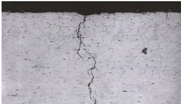
**Figure III.9:** Corrosion caustique [19].
