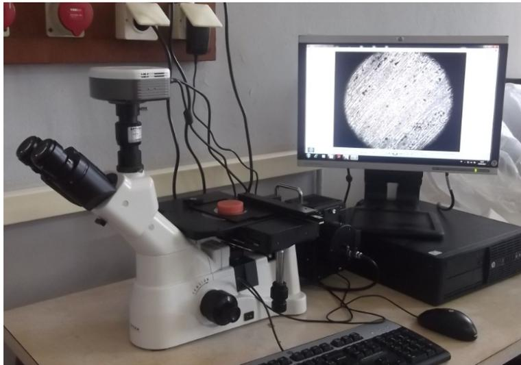
**Figure IV.2 :** Microscope métallographique OPTIKA M-789.
