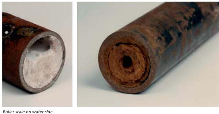
**Figure III.10:** Phénomène d'entartrage des tubes de chaudières [23].
