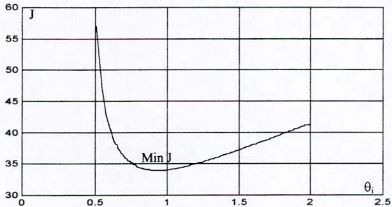
Fig 2-6 Variation de la fonction "J" en fonction de \theta_i = k_p, T_i et T_d
