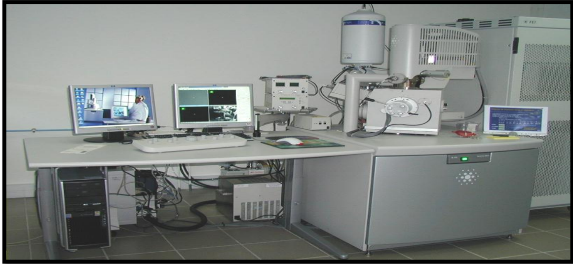
Figure III.6. Microscope électronique à balayage MEB.
