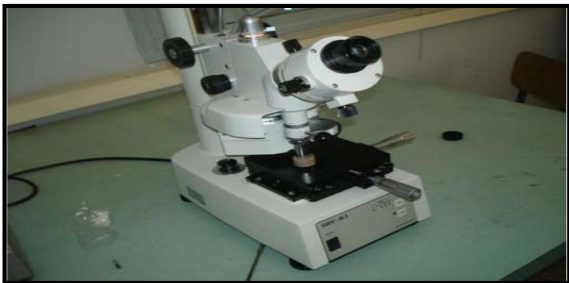
Figure III.7. Microduremètre SHIMATZU HMV-M3.
