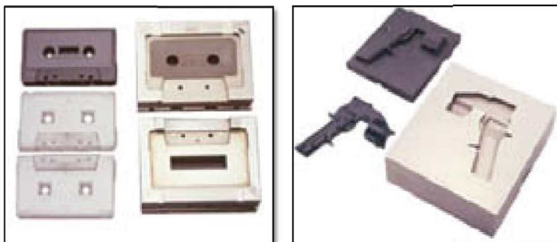
Figure I.10. Quelques pièces usinées par enfonçage [10].
