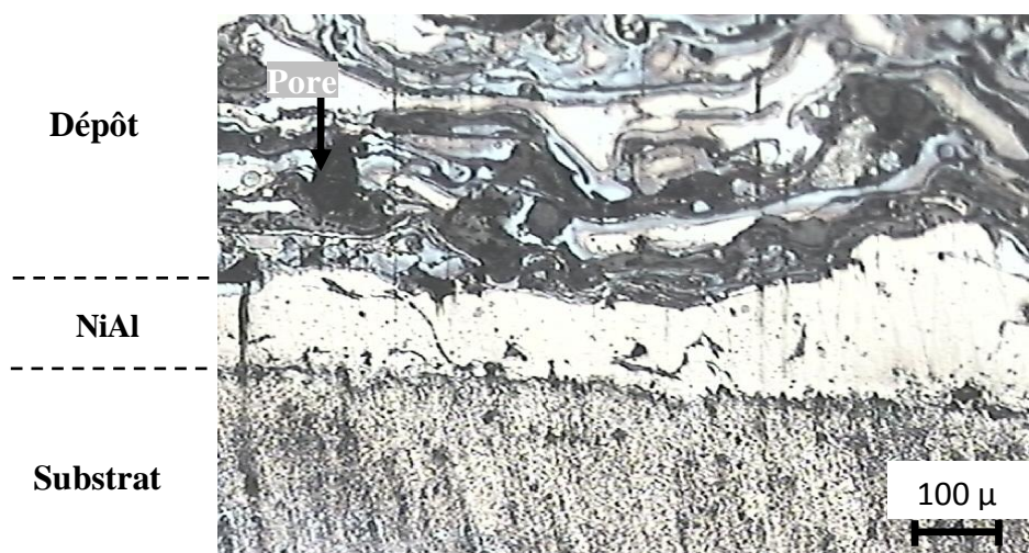
FIGURE V.3 - Métallographie du composite AG3/NiAl/ Thermanit, B+D.
