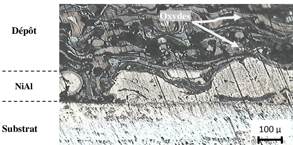
FIGURE V.6 - Métallographie du composite AU4G/NiAl/Thermanit, B+D.
