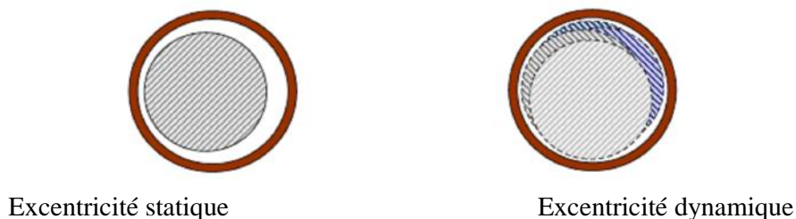
Figure I.9 : Les défauts d'excentricité [8]
