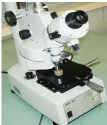
**Figure III.3 :** microduromètre SHIMATZU HMV-M3.
