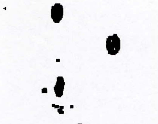
Fig(4-4) : Seuillage de l'image (4-3) avec un seuil de 50.
