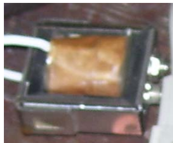
Figure III.4 Noyau E classique et sa carcasse de bobinage
