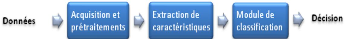
Figure III.5. Architecture générale d'un système de reconnaissance des formes.
