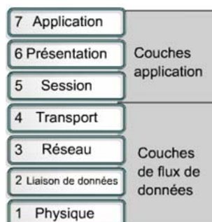
Figure II.1 : Le modèle OSI
