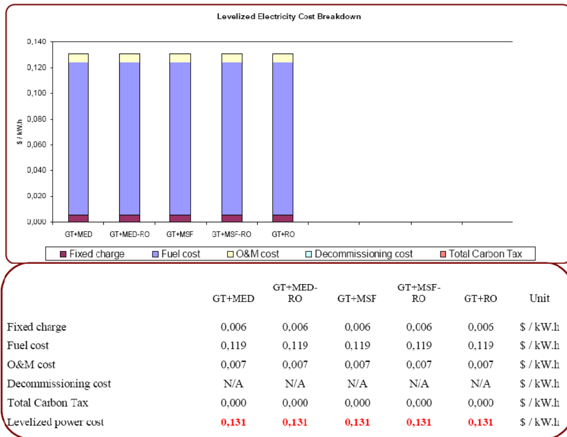
Figure III-8. Coût de production d'électricité pour le gaz.
