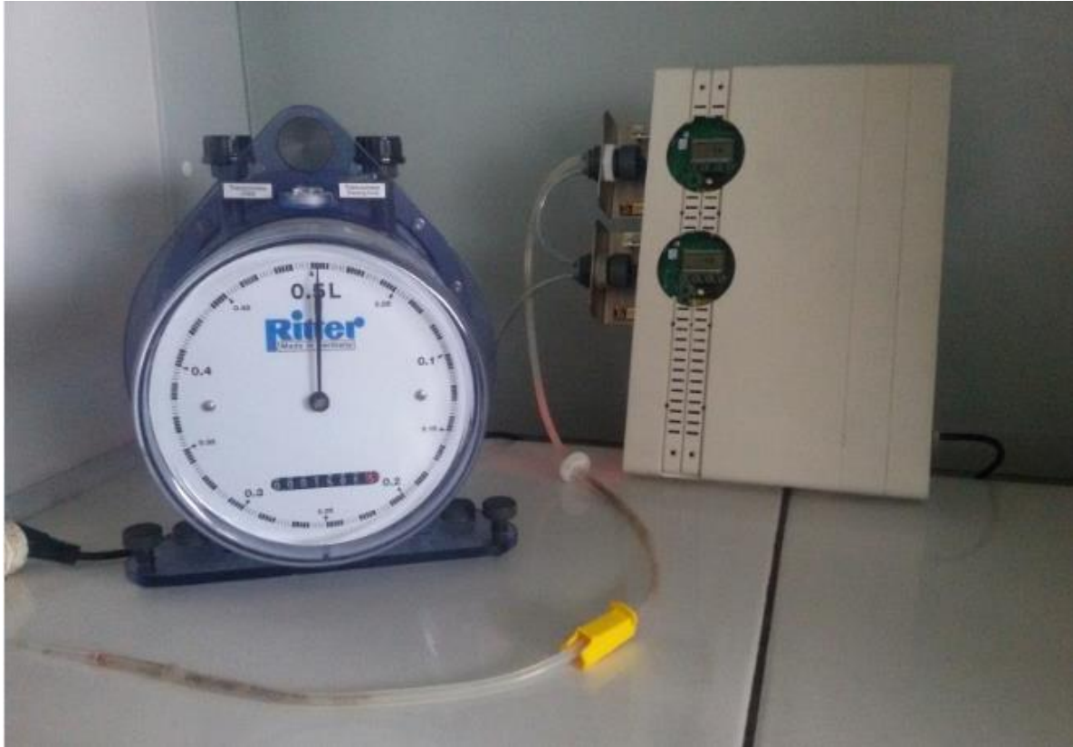
Figure 21: Compteur de gaz à tambour et l'analyseur CH 4 utilisés au laboratoire
