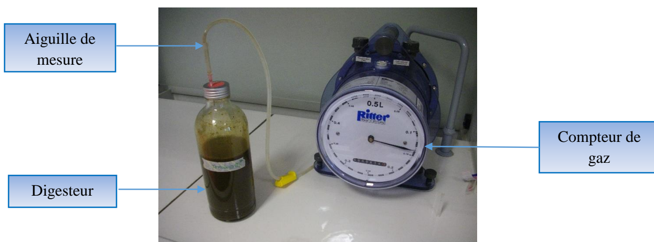
Figure 09: Dispositif expérimental des tests BMP au laboratoire de la ferme
