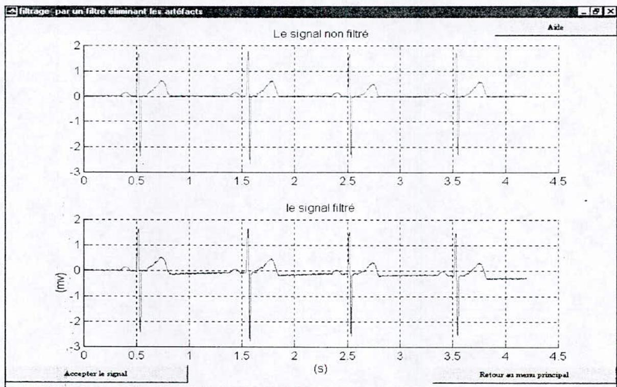
**Figure 14:** Filtrage du signal d'entrée par le filtre précédent.
