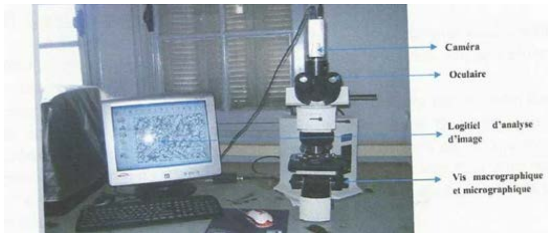
Figure III.4. Microscope optique muni d'une caméra numérique connecté à un microordinateur.
