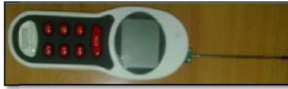
Figure I.6. La sonde utilisée pour le contrôle de la température du four d'élaboration.
