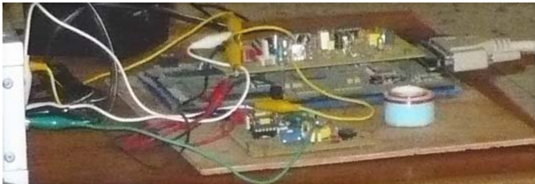
Figure 6-49: Circuits d'essai de traitement et de transmission de l'implant cochléaire
