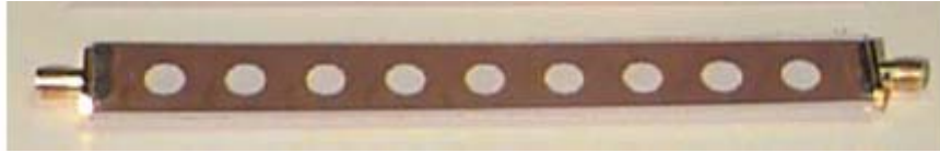
Figure 2.3 Filtre BIE basé sur l'usinage du plan de masse d'une ligne microruban (source [28]).
