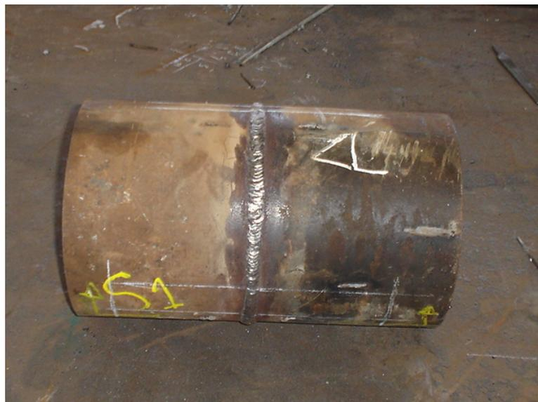
**Figure 3.3.** Le tube soudé avant le prélèvement des échantillons
