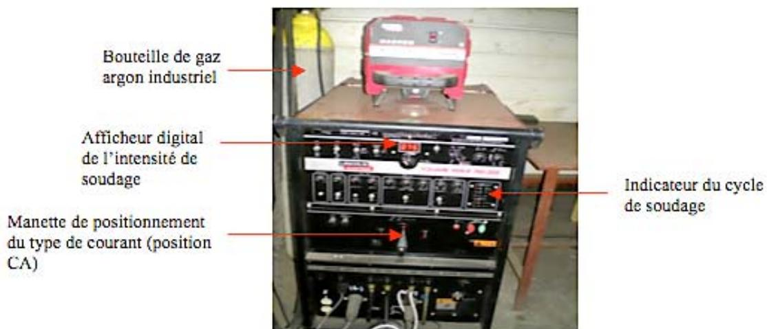
Figure27 : Poste de soudage TIG(C.S.C)
