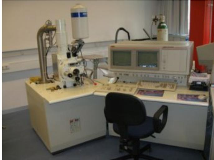
Figure 36 : Le microscope électronique à balayage (ENSAM)
