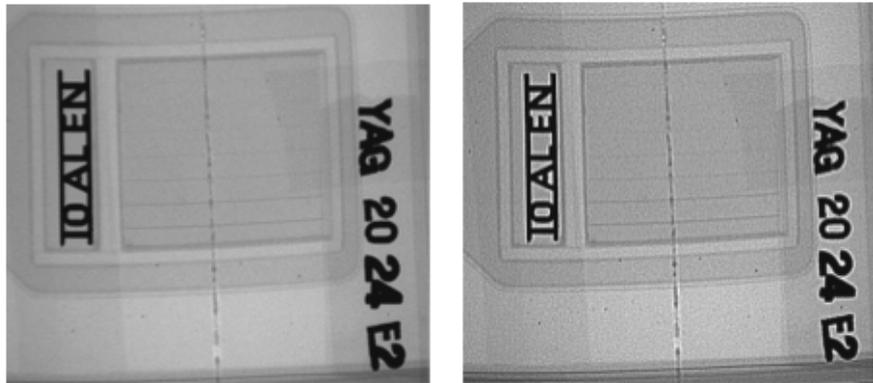
Figure56 : Film radiographique de la soudure laser2
