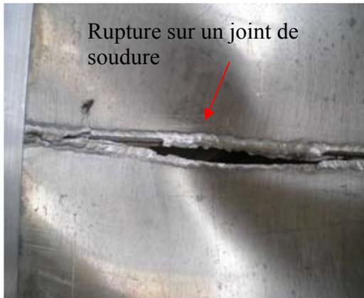
Figure 22 : Rupture du joint de soudure
