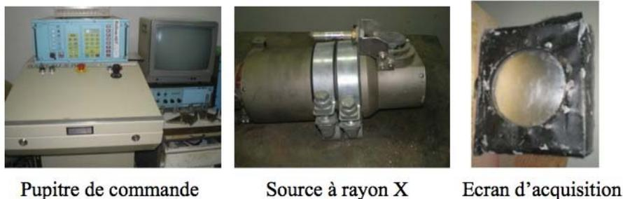
Figure 35 : Composants du radioscope (C.S.C)
