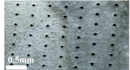
Figure 103 : Profil de prélèvement de microdureté sur la soudure laser4
