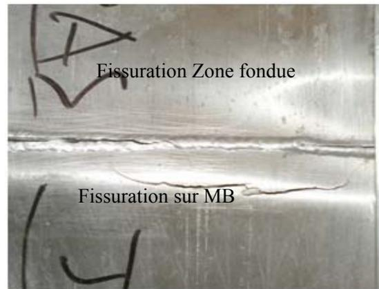
Figure 23 : Fissuration du métal de base et la zone fondue
