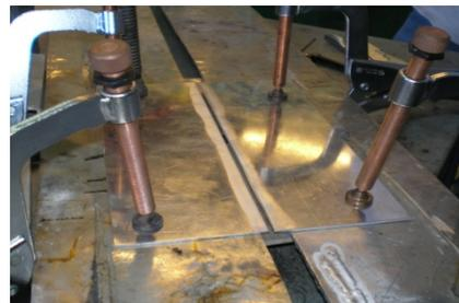
Figure 30 : Système de bridage des tôles
