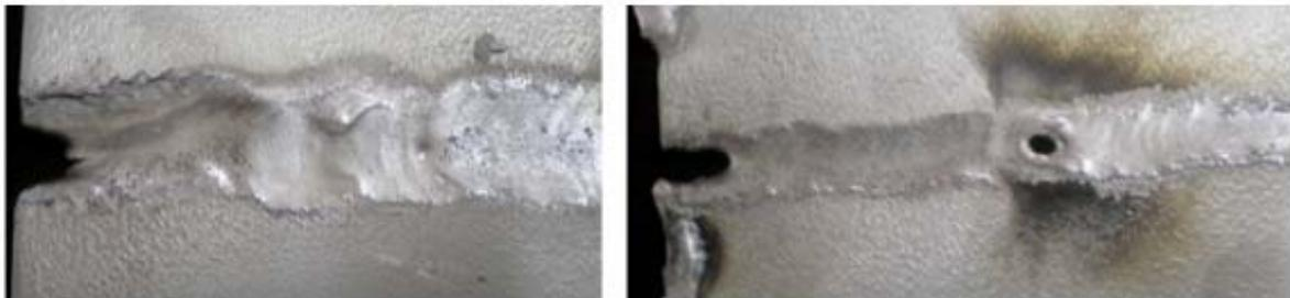
Figure 44 : Effet des courants forts sur le joint de soudure en mode de soudage manuel
