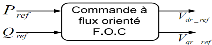
Figure II.5 : Bloc de contrôle à flux orienté
