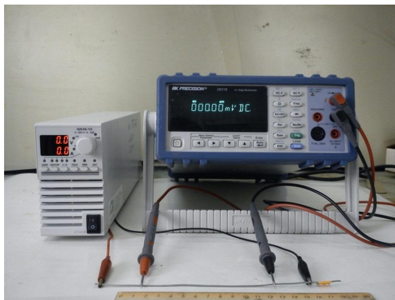
Figure III.5 : Dispositif expérimental pour mesurer la tension et l'intensité de courant.
