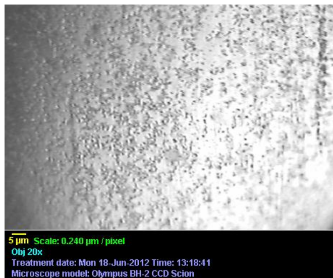
FigureIV.1 : Structure d'un fil neuf en laiton CuZn37, poli mécaniquement non attaqué.
