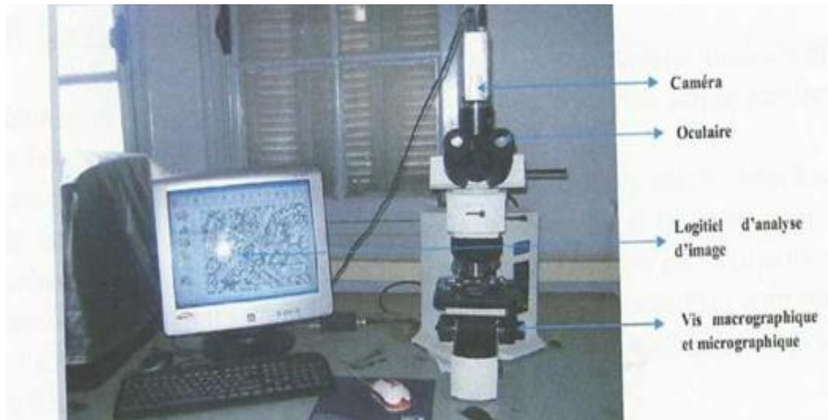
Figure III.3 : Dispositif expérimental de l'observation microscopique.
