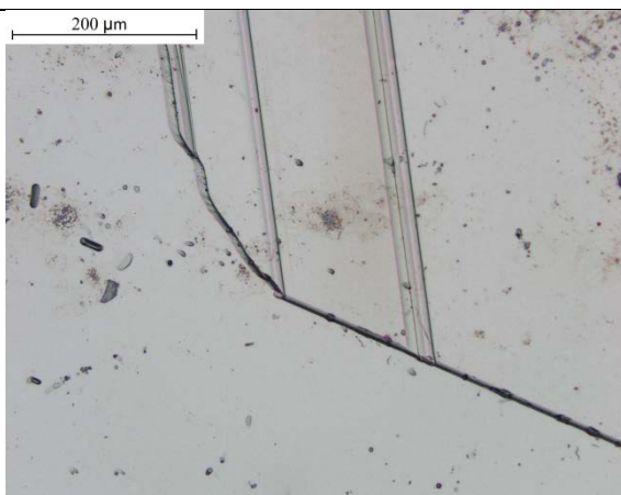
Figure III.23 : mise en évidence des densités de dislocation échantillon recuit pendant 4 heures
