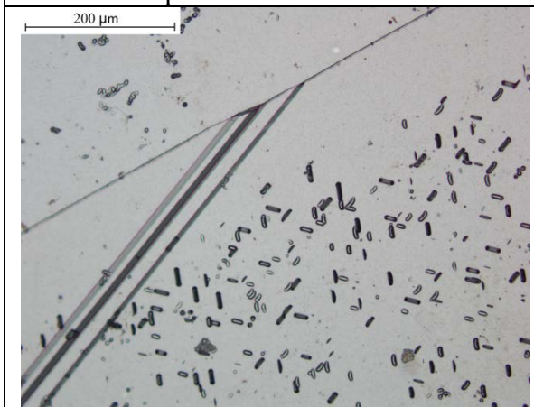
Figure III.34 : mise en évidence des densités de dislocation échantillon recuit pendant 10 heures
