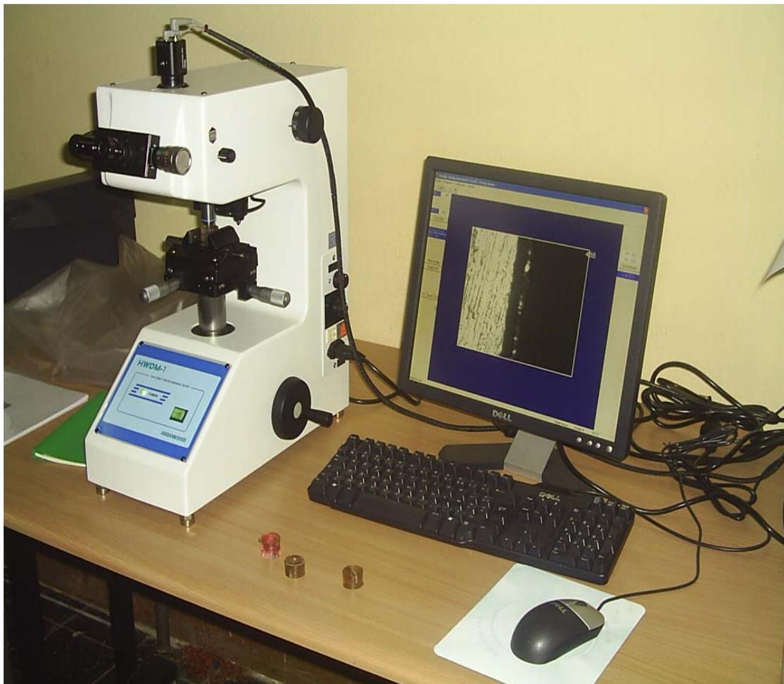
**Figure II.8.** Microduromètre.
