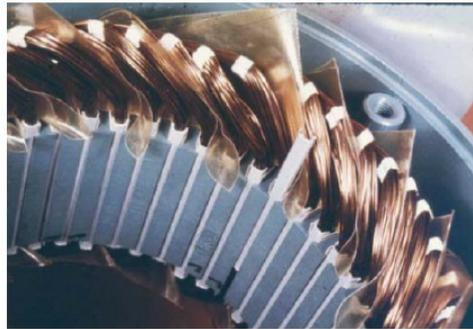
FIGURE 1.10 – Photographie mettant en évidence l'isolation entre phases (têtes de bobines) d'un bobinage distribué triphasé [31]
