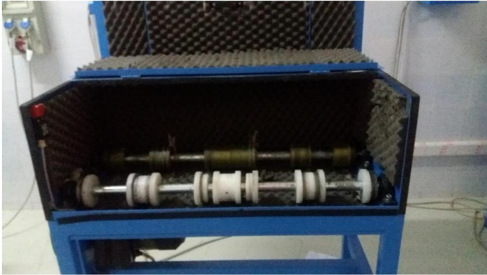
Figure 01 :L'appareil de Micro Deval.
