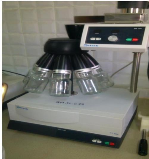
Figure IV. 3: échantillonneur rotatif.
