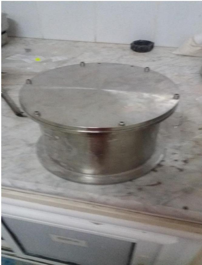
Figure 02 :Cylindre de l'appareil de Micro-Deval.
