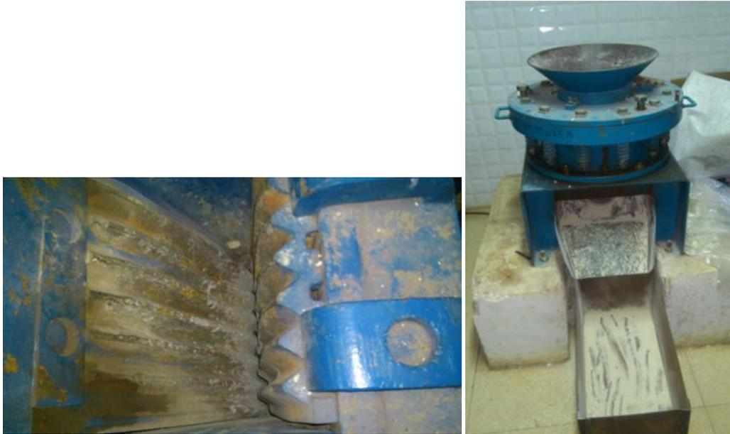
Figure IV. 2: Concasseur à mâchoires et Concasseur à cône
