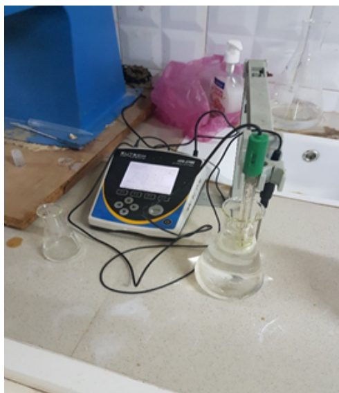
FIGURE 3.8: Valeur du pH est enregistrée durant tout le processus à l'aide du pH-mètre
