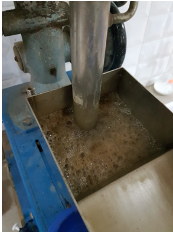
FIGURE 3.7: Agitation de la pulpe au sein de la cellule de flottation
