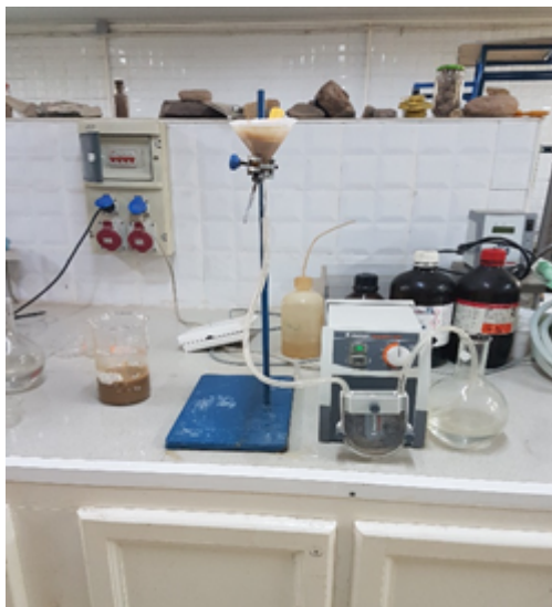
(a) Pompe de filtration de type Heidolph
