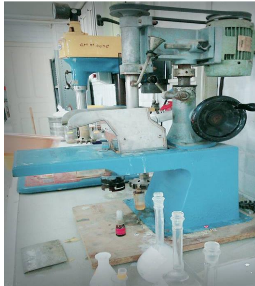
Figure 46 : cellule de flottation (type soviétique).
