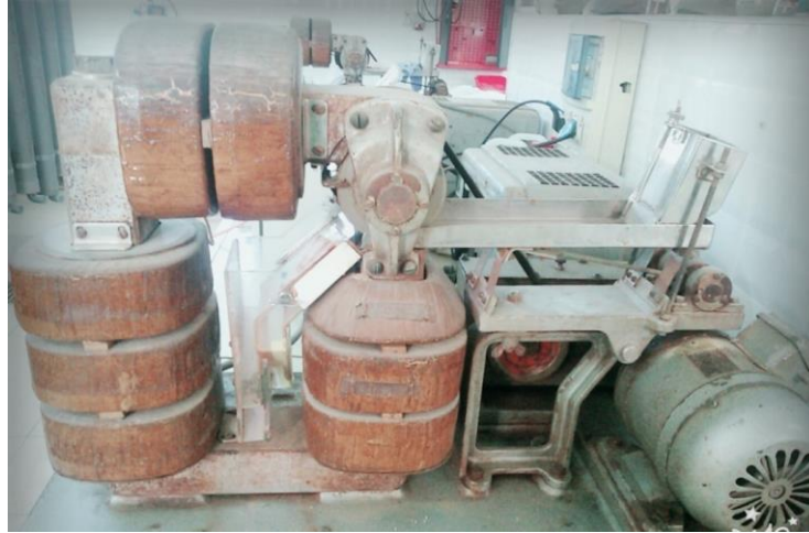
Figure 35: Séparateur magnétique SMHI (SMBI).
