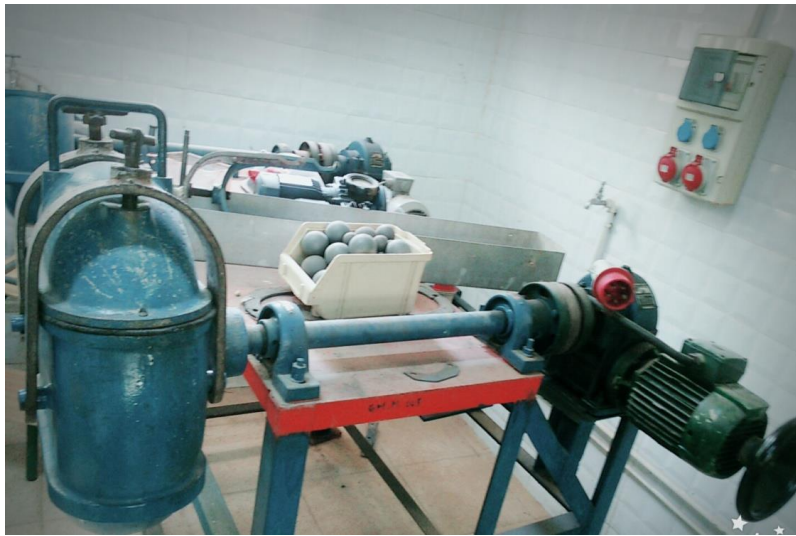
Figure 29 : Broyeur à boulets.
