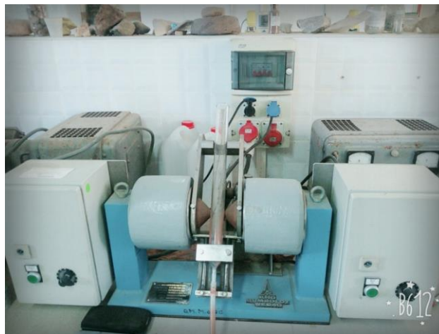
Figure 34: séparateur magnétique par voie humide.
