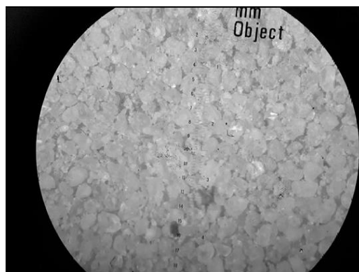
Figure 39 : séparation magnétique de La classe [-250+40] \mu\text{m} .
