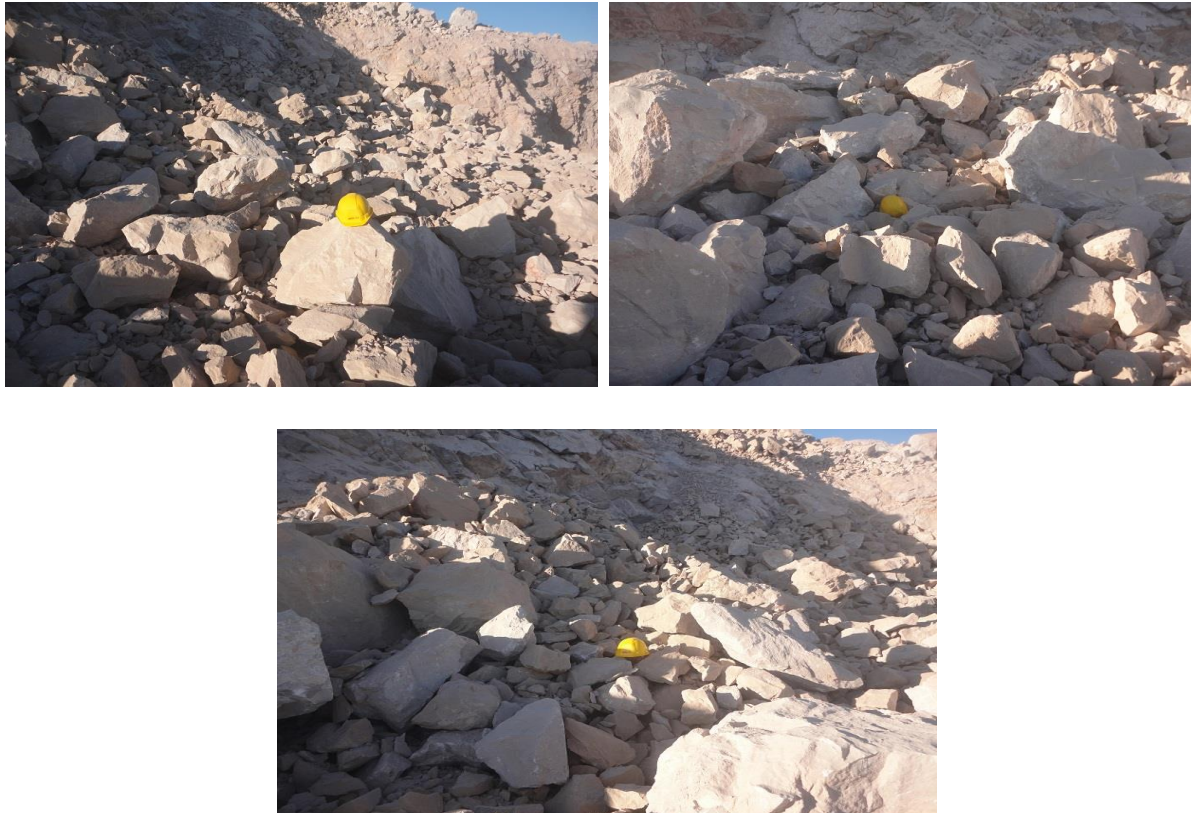
Figure V.1. Images d'un tas de roche fragmentée à échelle à l'aide d'un appareil photo numérique.
