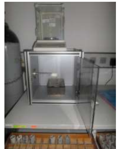
Figure IV.4: Dispositif de mesure du Poids par Immersion.
