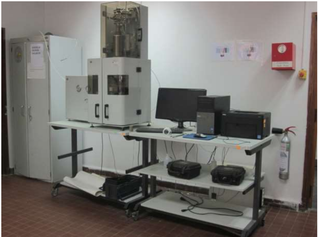
Figure IV:3 : Appareil de mesure des paramètres Pétrophysique sous Confinement Laboratoire Pétrophysique DTD.
