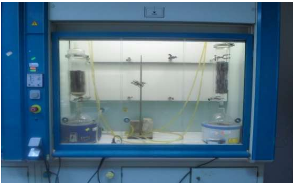
Figure IV.2: Lavage des échantillons par Reflux aux SOXLHET Laboratoire Pétrophysique DTD.
