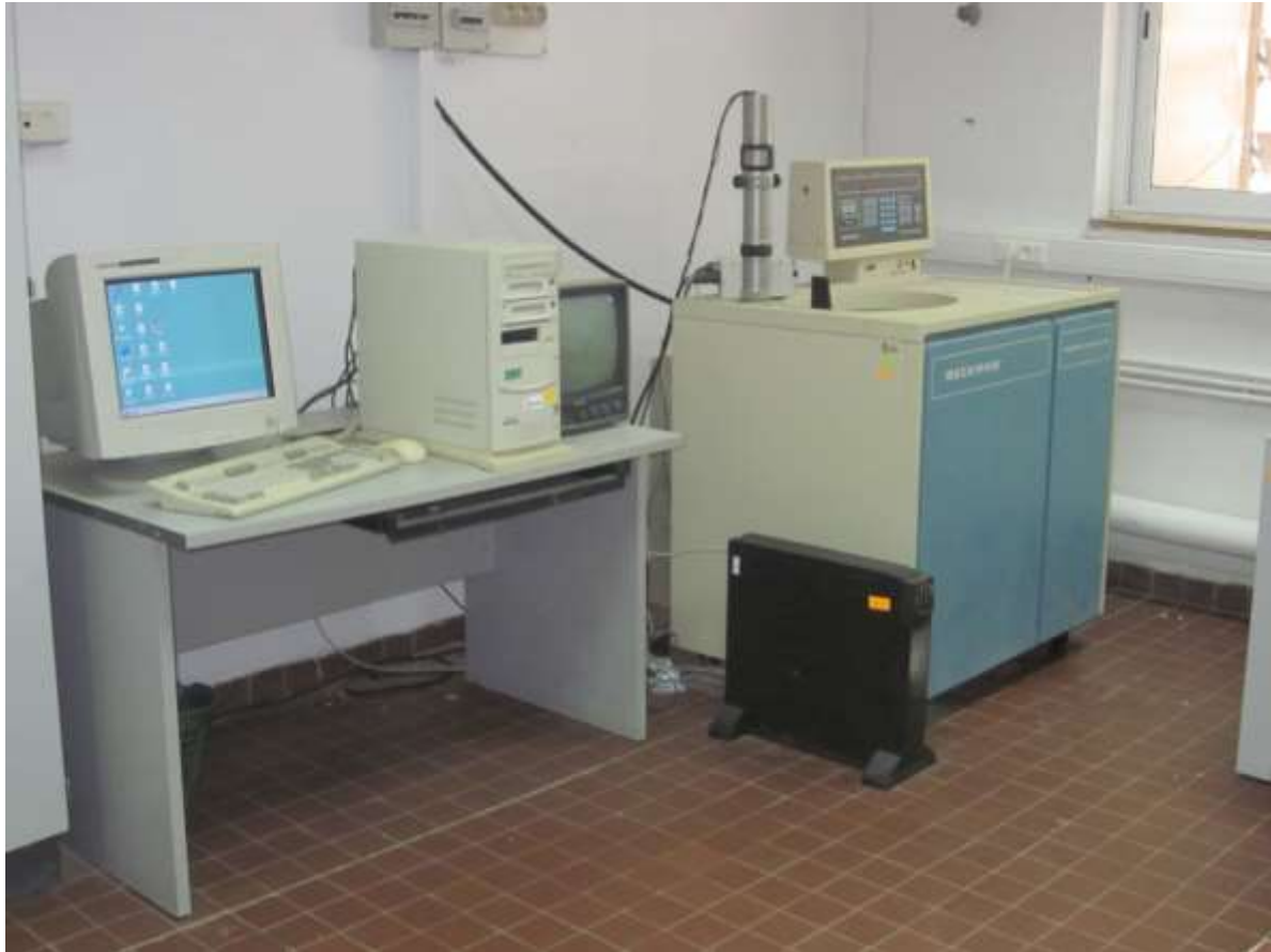
Figure IV.5: Mesure de la Pression Capillaire par Centrifugation de type BEKMAN L8-70M. Laboratoire Pétrophysique DTD.
