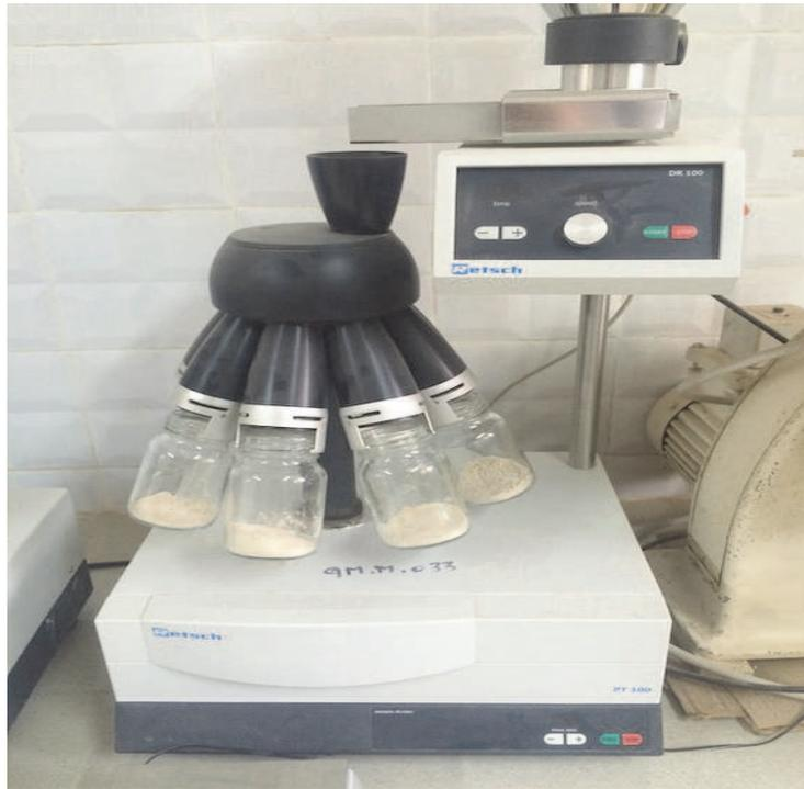
Fig. 18 : Échantillonneur rotatif pour répartition homogène des échantillons
