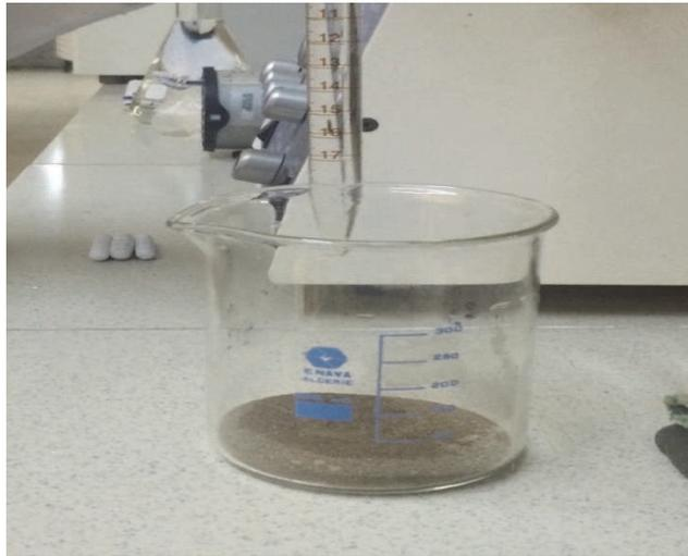
Fig.22 : Attaque du minerai phosphaté par l'acide sulfurique
