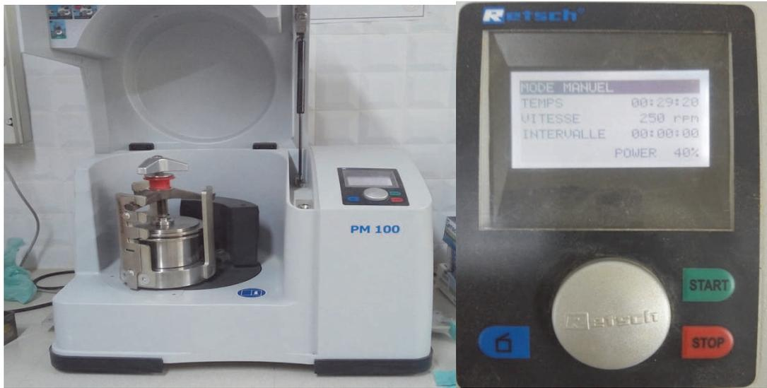
Fig.20 : Préparation du produit pour un broyage fin de 30 minutes
