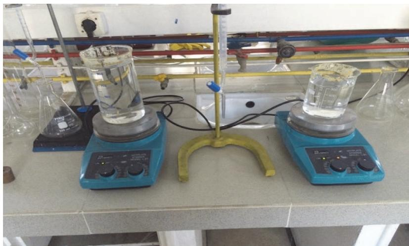
Fig. 15 Préparation des solutions A, B et C par Agitation Magnétique et chauffage à ébullition sur plaques chauffantes électriques
