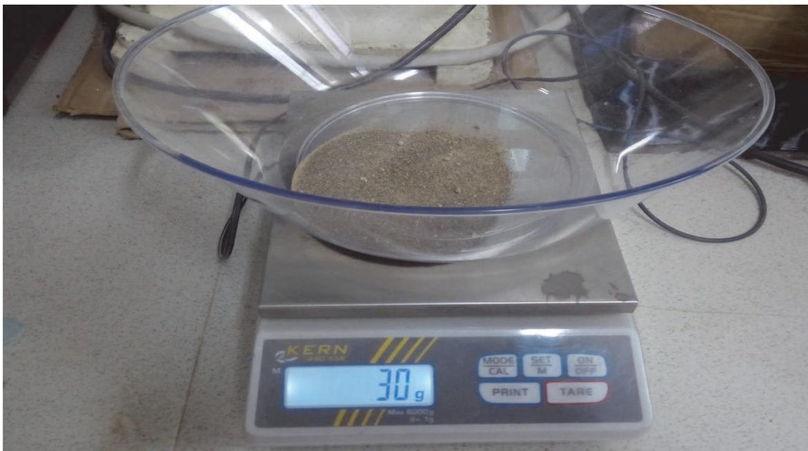
Fig. 19 : Balance électronique de laboratoire à précision 0,001mg
