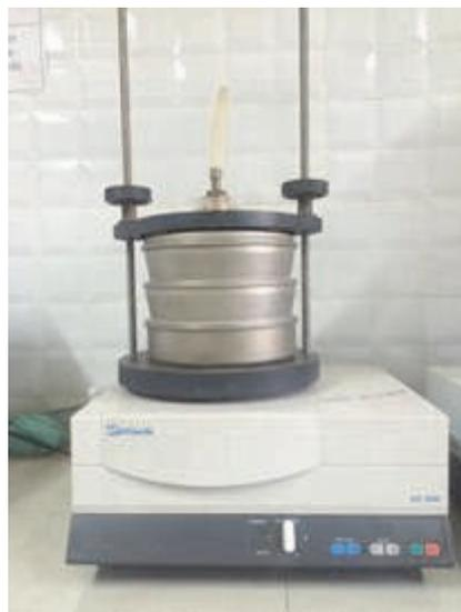
Fig. 17 : tout venant tamisé à une granulométrie inférieure à 250 microns
