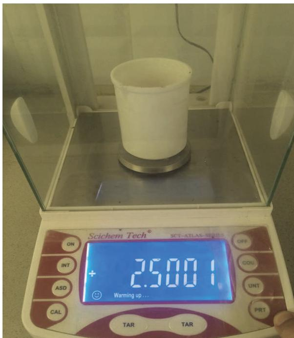
Fig.30 : Balance électronique sensible à précision 0.001mg
