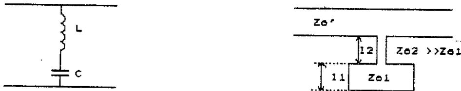
FIG II-7-a : réalisation d'un circuit résonnant placé en dérivation
