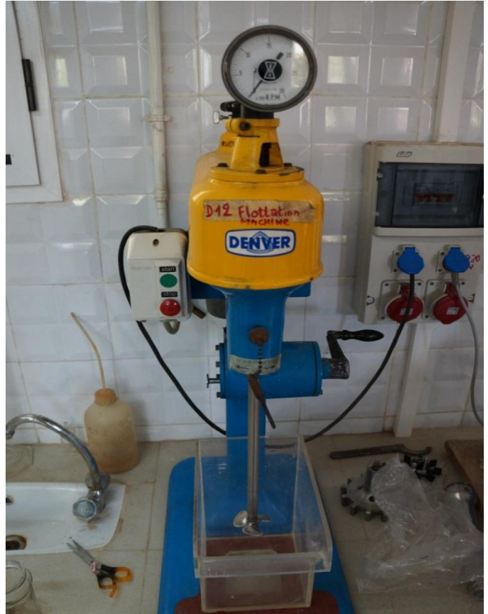
Figure V.13 : Photo d’une cellule de flottation DENVER.
