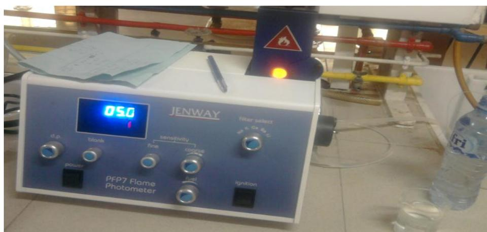
**Figure 19 Calibrage du photomètre par des solutions standards**
