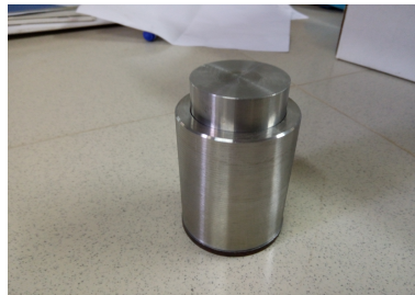
FIGURE 5.32 – La cellule 2 en acier de dureté supérieur au Rockwell C43.
