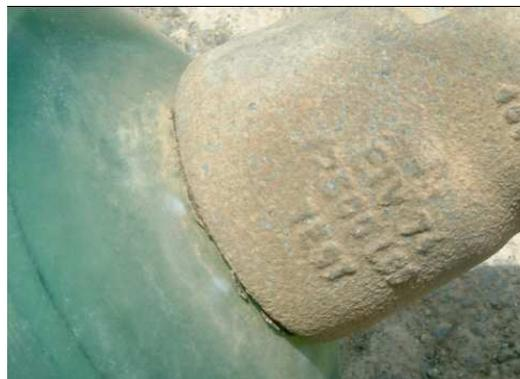
**Figure IV.5:** dégradation entre le capot et la surface de l'isolant
