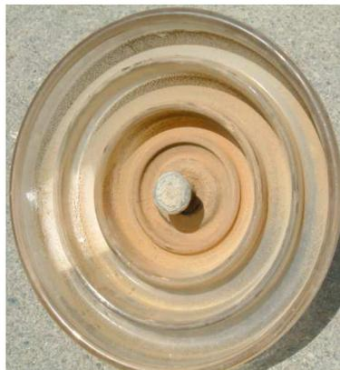
**Figure III.2 :** Isolateur à profil standard.
