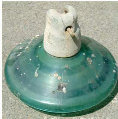
**Figure III.8 :** Isolateur à profil antibrouillard N° 14 taché par la peinture.
