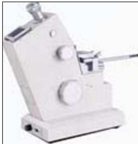
**Figure V.11 :** Réfractomètre utilisé dans la mesure de l'indice de réfraction
