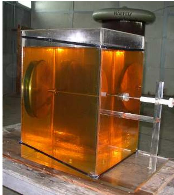
**Figure (V.2) :** Cellule d'essais
