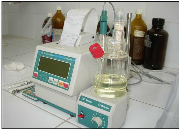
**Figure V.9 :** 756 Karl Fisher utilisé dans la mesure de la teneur en eau
