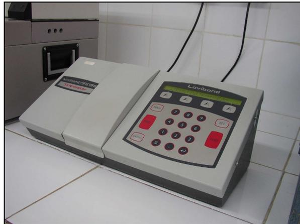
**Figure V.10:** Lobivond PFX Automatic Colometer utilisé dans la mesure de l'indice de couleur
