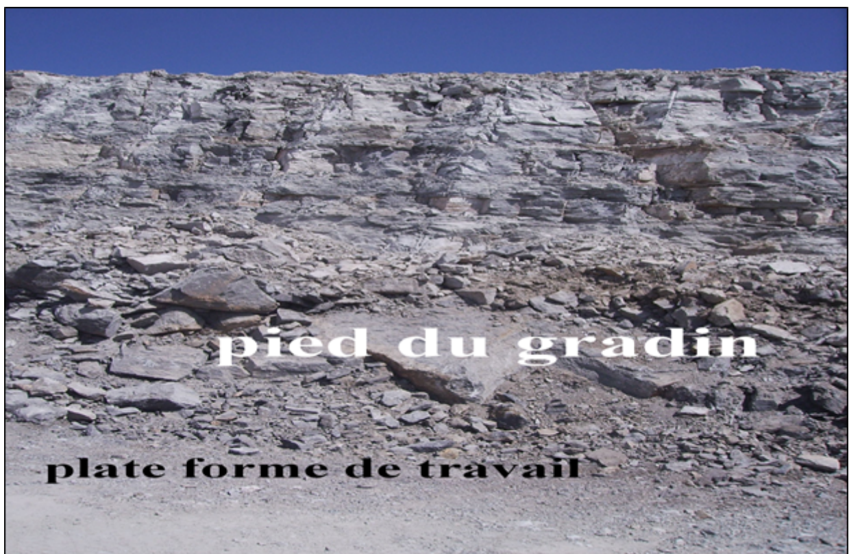
FIGURE V.2 – Vue du massif rocheux montrant un mauvais tir au niveau du pied du gradin
