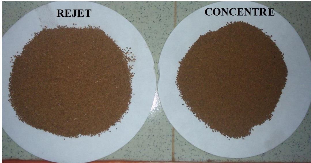
Figure IV.24 : Différence de couleur entre le concentré et le rejet, pour une séparation magnétique (0.8- 0.5 mm)
