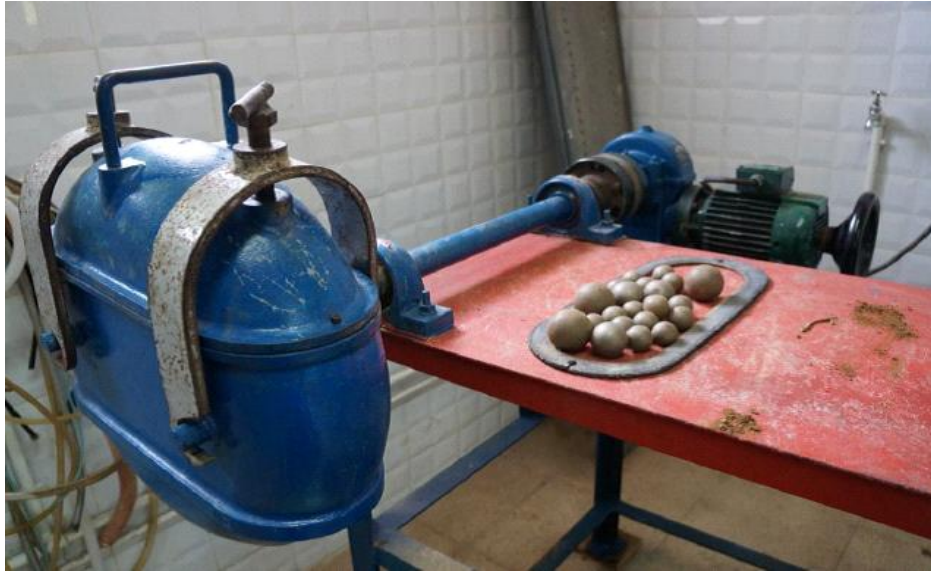
Figure IV.4 : Broyeur à boulets
