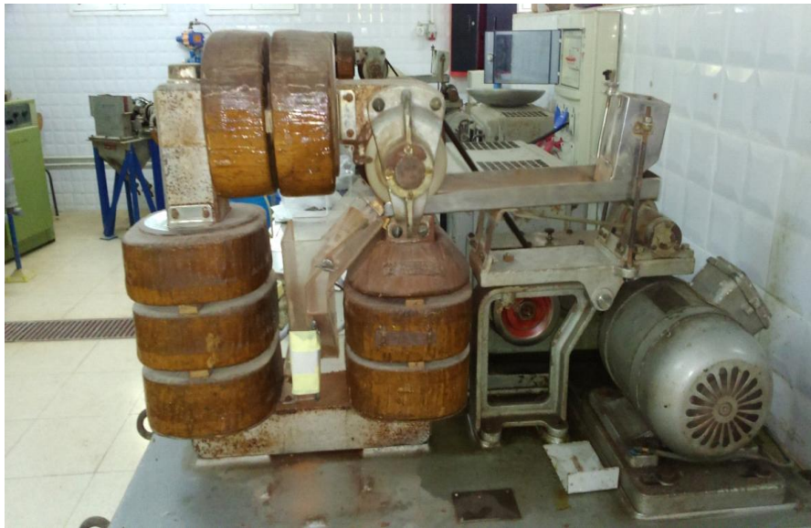
Figure IV.11: Séparateur magnétique à haute intensité
