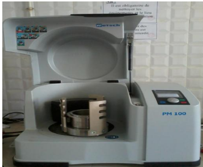
Figure IV.34 : Broyeur à billes de type Retsch PM-100.
