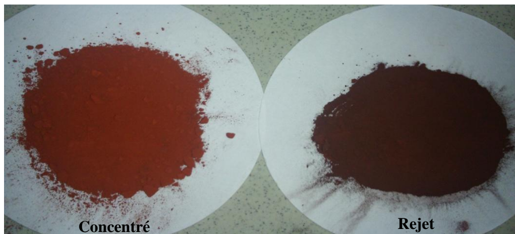
Figure IV.40 : Différence de couleur obtenue par flottation pour la classe granulométrique (<80 µm)
