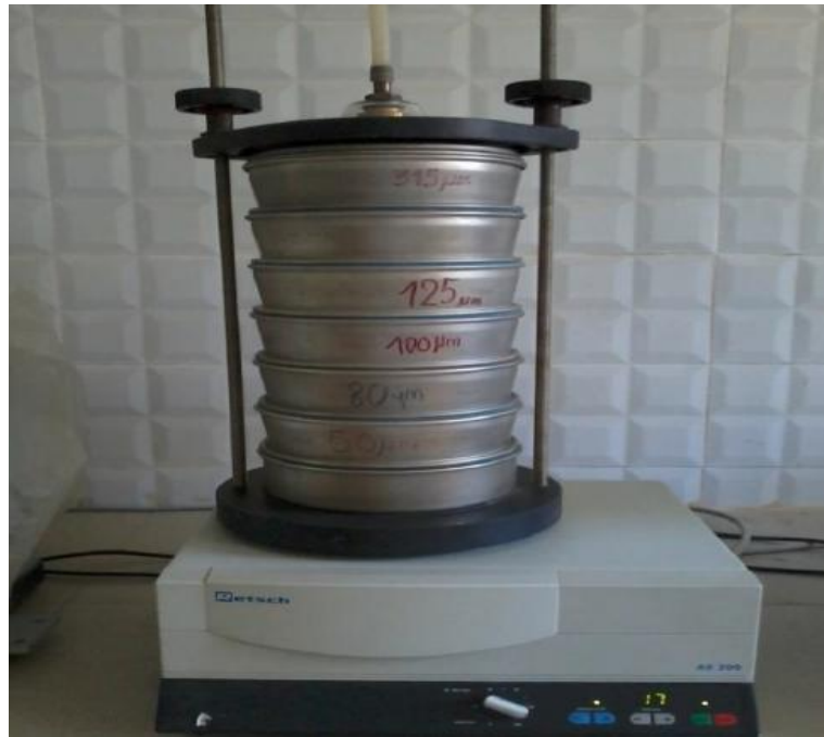
Figure IV.9 : Tamiseuse électrique de type Retsch- AS 200
