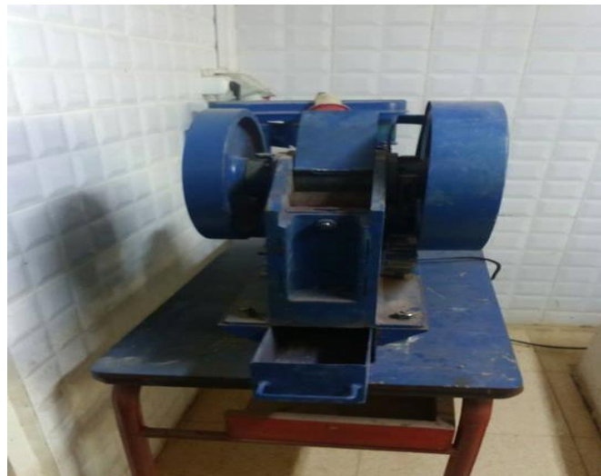
Figure IV.3 : Concasseur à mâchoires
