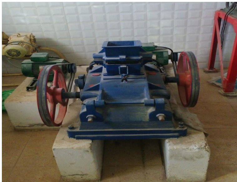
Figure IV.33 : concasseur à cylindre.
