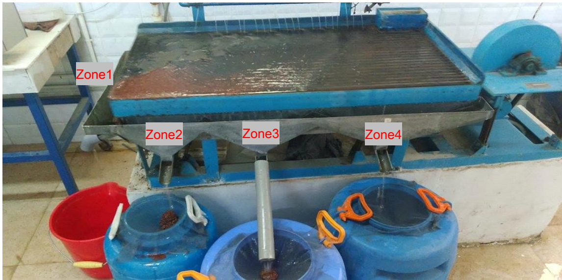
Figure IV.27 : Table à secousse
