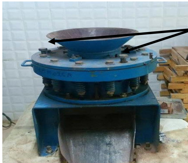
Figure IV.2 : Concasseur giratoire de type DENVER
