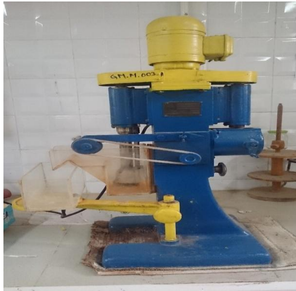
Figure IV.35 : cellule de flottation
