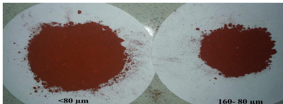
Figure IV.43: Différence de couleur entre les concentrés obtenus par flottation pour les classes granulométriques <80 \mu\text{m} et - 160 +80 \mu\text{m}
