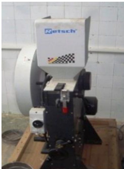
Fig V.1. Concasseur à mâchoire utilisé
