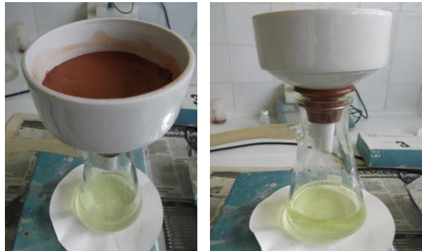
Fig V.8. Filtration et lavage
