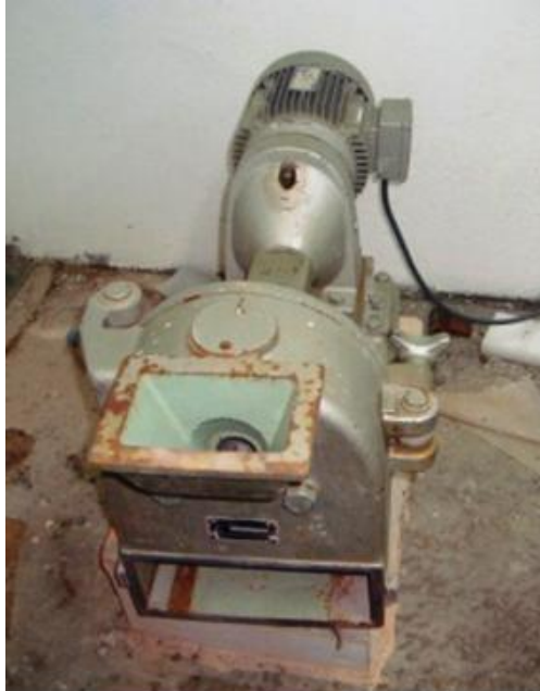
Fig V.2. Broyeur à disque utilisé
