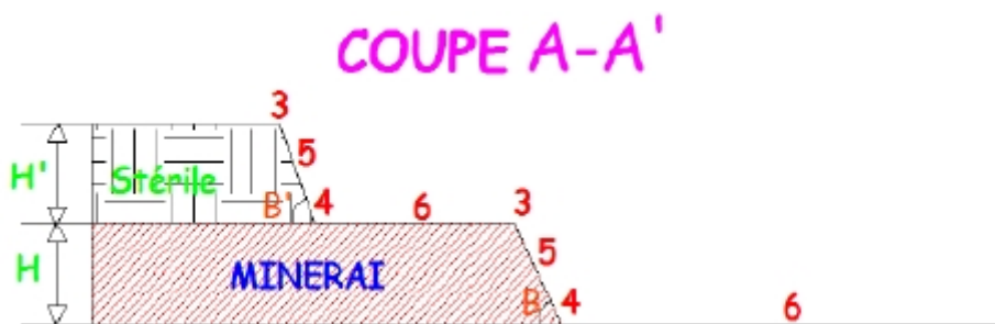
Figure IV.2 : Coupes à travers les gradins.
