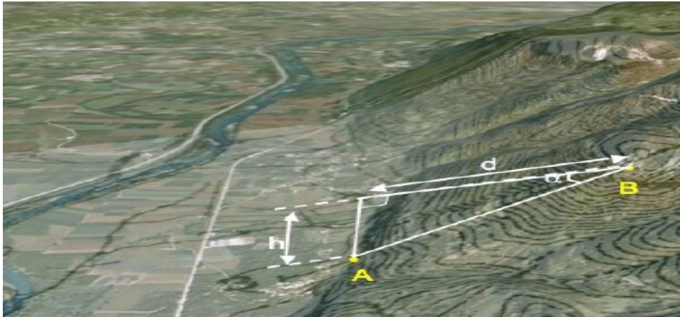
Figure III.1: les éléments de pente
