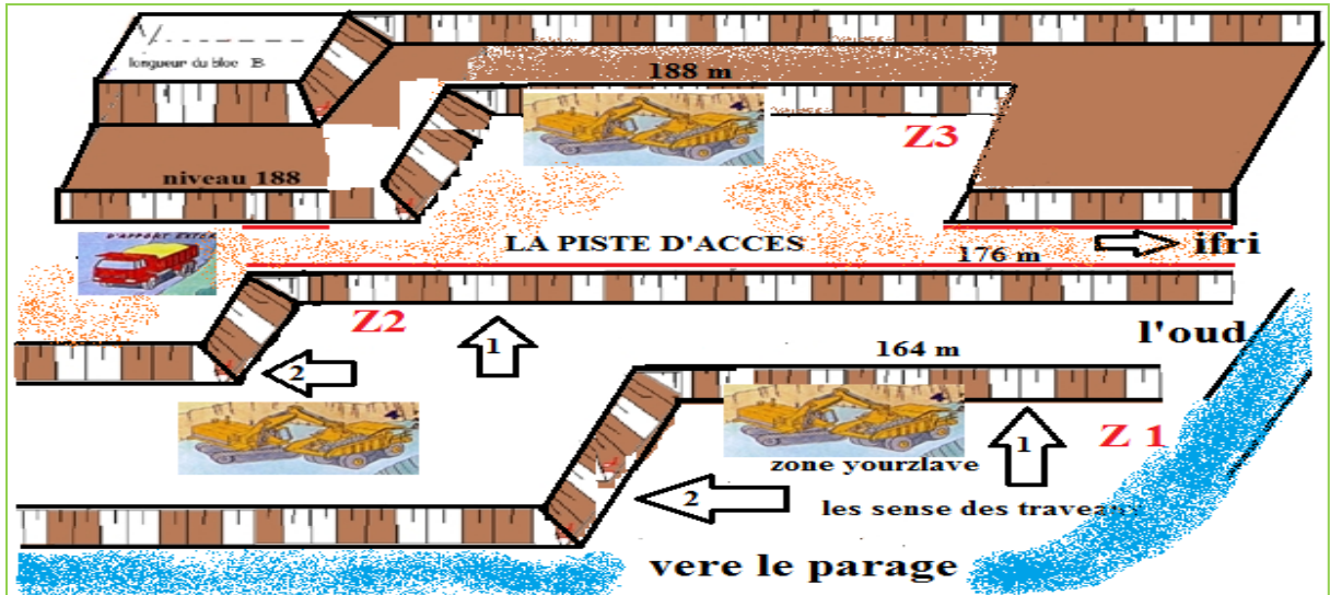
Figure III .8: la méthode d'exploitation de la partie submergé étape 2.
