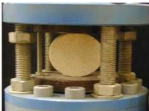
**Figure I.7:** Dispositif expérimental (Essai Brésilien)
