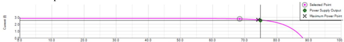
Figure 4.40 : le courant en fonction de la tension avec un rendement de 96.25%.
