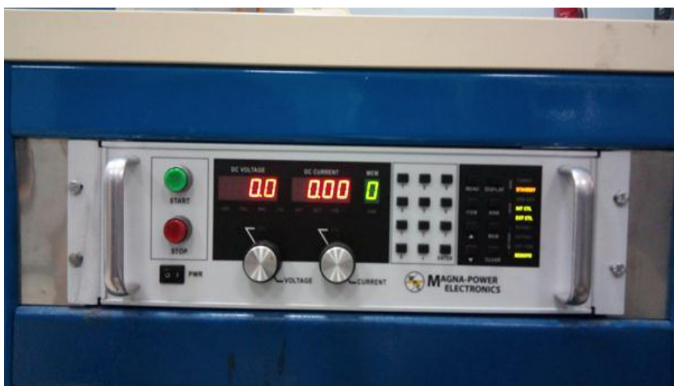
Figure 4.2 : l'émulateur PV (Magna Power Electronics 600V / 24A).
