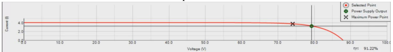
Figure 4.46 : le courant en fonction de la tension avec un rendement de 91.22%.
