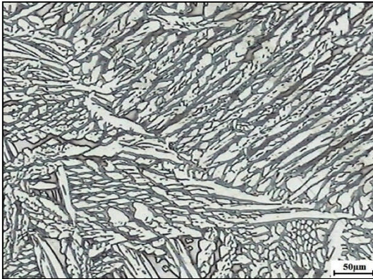
Figure IV.10 : Vieillissement de la ZF après 100h à 350°C
