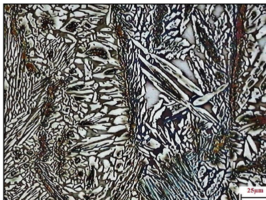
Figure IV.22 : Vieillissement de la ZF après 500h à 475°C
