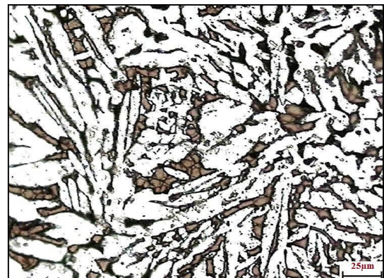
Figure IV.42 : La ZF après 10 cycles à 1050°C
