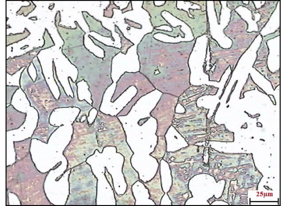
Figure IV.50 : La ZAT après 10 cycles à 1200°C
