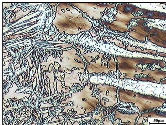
Figure IV.9 : Vieillissement de la ZAT après 500h à 350°C
