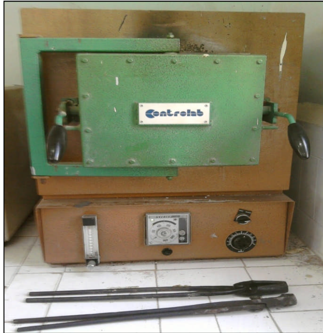
Figure III.3 : Four des traitements thermiques température max 1200°C
