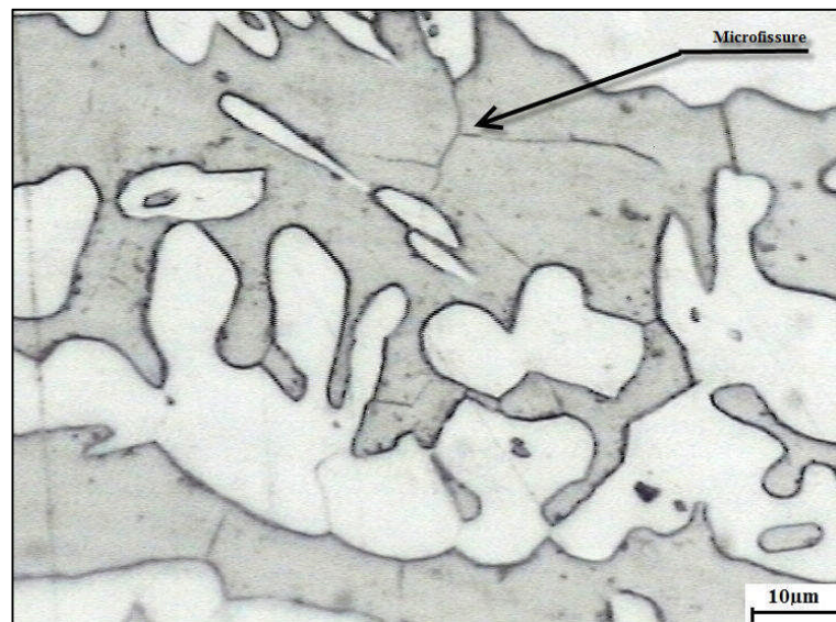
Figure IV.63 : Microfissures intragranulaire dans la ZAT après 10 cycles à 1050°C
