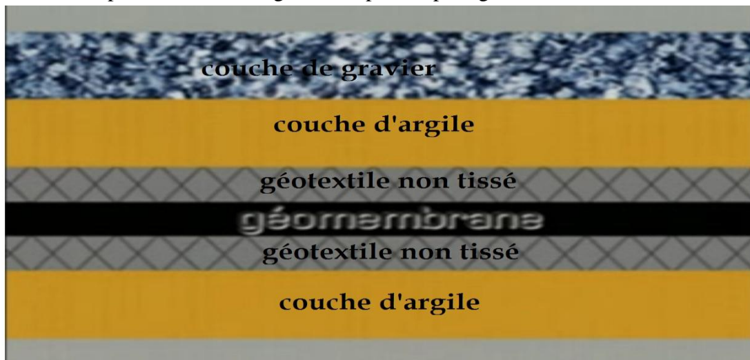
Figure II.4.5.1.1 : Casier d'enfouissement-vue en coupe
