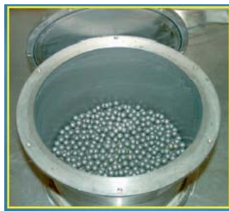
Figure I.27- Tambour avec billes en acier.
