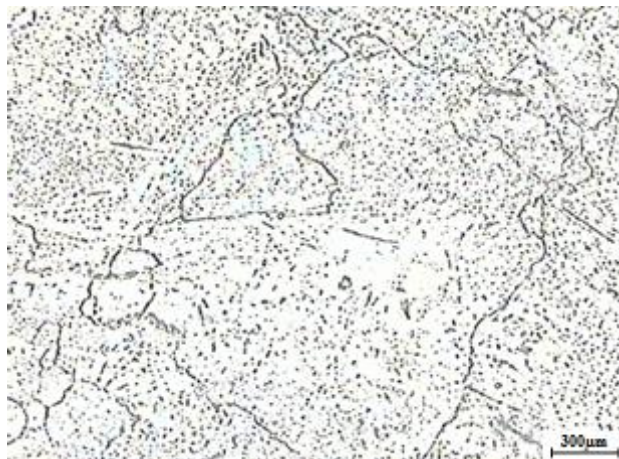
Figure 65. Micrographie reflétant un état avancé de la polygonalisation du Zn caractérisant les échantillons 7', V et G.
