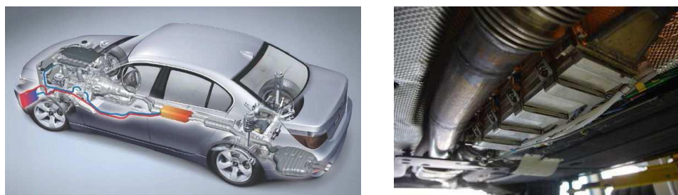
Figure 11. Conception d'un générateur thermoélectrique produisant de l'électricité de la chaleur perdue au niveau du pot d'échappement d'un véhicule (source BMW) [3].
