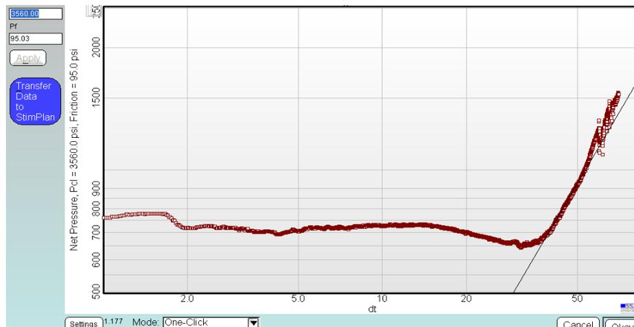
**Figure 4.13** Courbe Log-Log de la pression nette en fonction du temps
