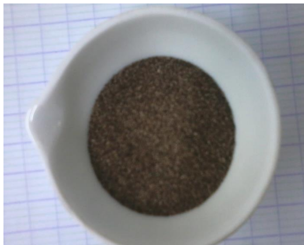
Figure VI-2 : Creuset en porcelaine utilisé dans la calcination.
