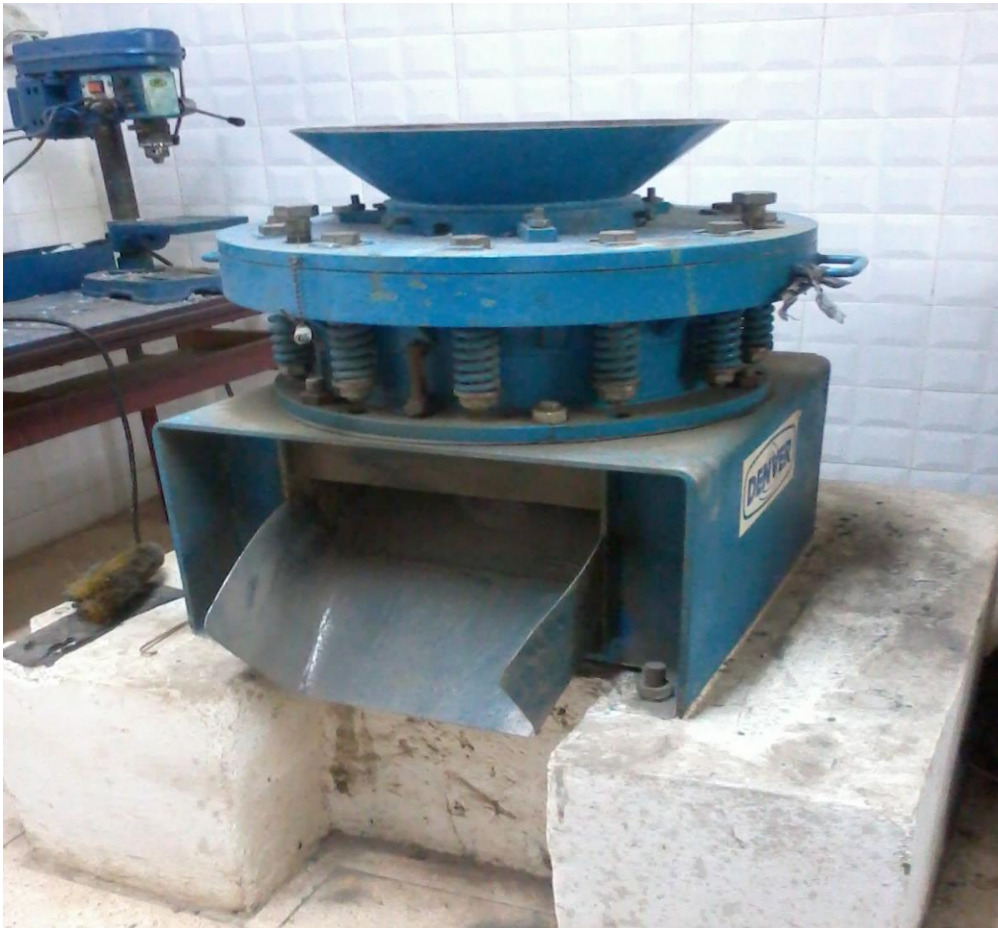
Figure IV-1 : Concasseur à cône giratoire de type DENVER.
