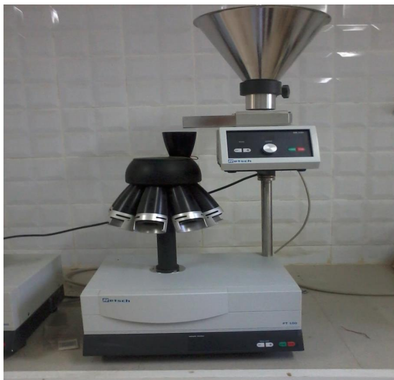
Figure IV-3 : Echantillonneur automatique de type Retsch - PT 100.
