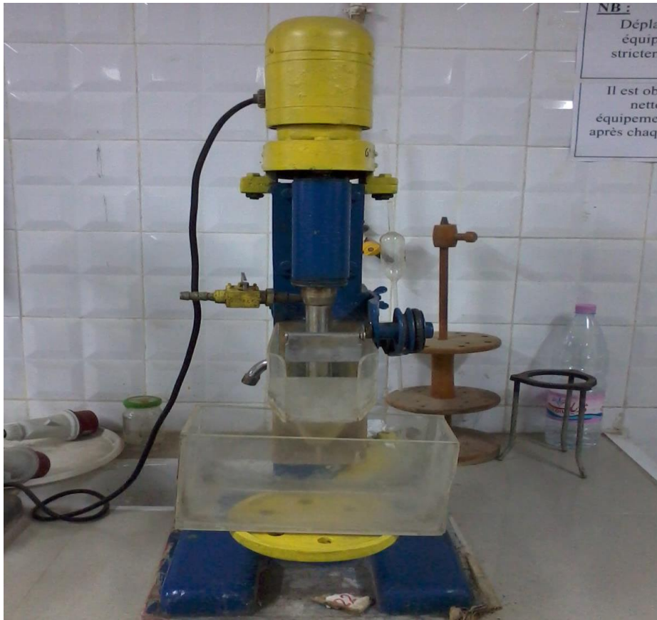
Figure V-2 : Cellule de flottation utilisée au laboratoire de Génie Minier.
