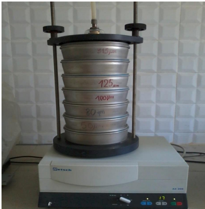
Figure IV- 4 : Tamiseuse électrique de type Retsch- AS 200
