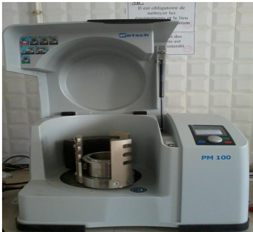
Figure V-1 : Broyeur à billes de type Retsch - PM 100.
