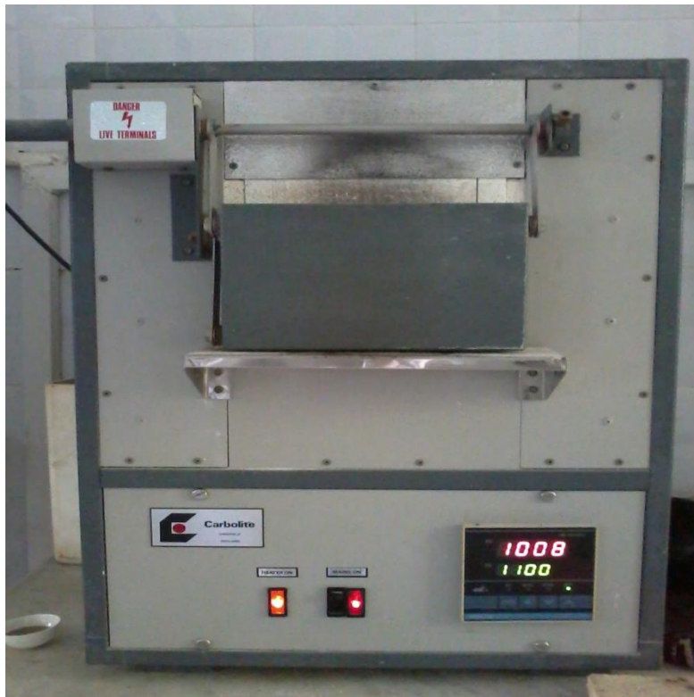
Figure VI -1 : Four de laboratoire de type Carbolite .
